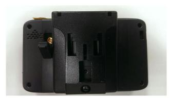
2. MCX 外付アンテナプラグを 6000S デバイスのアンテナ接続ポートに 垂直方向で差し込みます。
